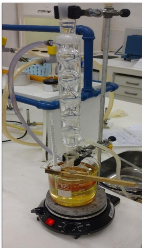
Figura 6 - Sistema de síntese do terpineol. Béquer com óleo de soja e agitação magnética. Termômetro para estabilizar a temperatura entre 80 e 85 °C. Balão de 250 mL. Coluna de Allihn para condensação da solução reacional.
