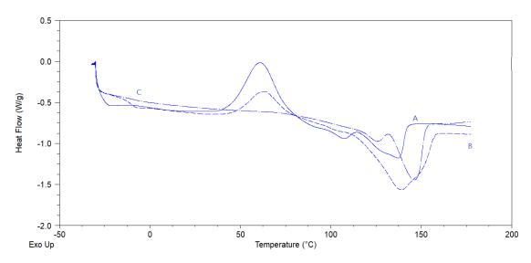
Figura 21 – Curva de DSC do P(3HB) (segundo ciclo de aquecimento) obtido das extrações realizadas com clorofórmio (A), hipoclorito de sódio (B), mistura (C) e de biomassa crescida utilizando como substrato a glicose
