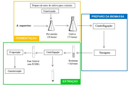
Figura 8 – Fluxograma das etapas desenvolvidas experimentalmente
