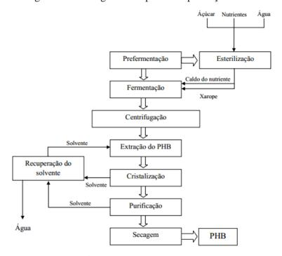
Figura 3 – Fluxograma do processo produção do PHB.
