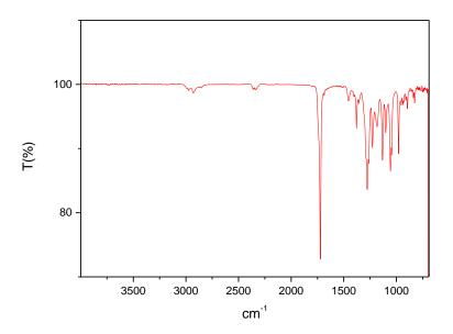
Figura 17 – Especto de FTIR do P(3HB) obtido das extrações realizadas com clorofórmio (A), mistura (B) e hipoclorito de sódio (C) de biomassa crescida utilizando como substrato glicerol residual
