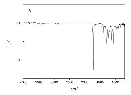
Figura 18 – Espectos de FTIR do P(3HB) obtido das extrações realizadas com clorofórmio (A), mistura (B) e hipoclorito de sódio (C) de biomassa crescida utilizando como substrato a glicose.
