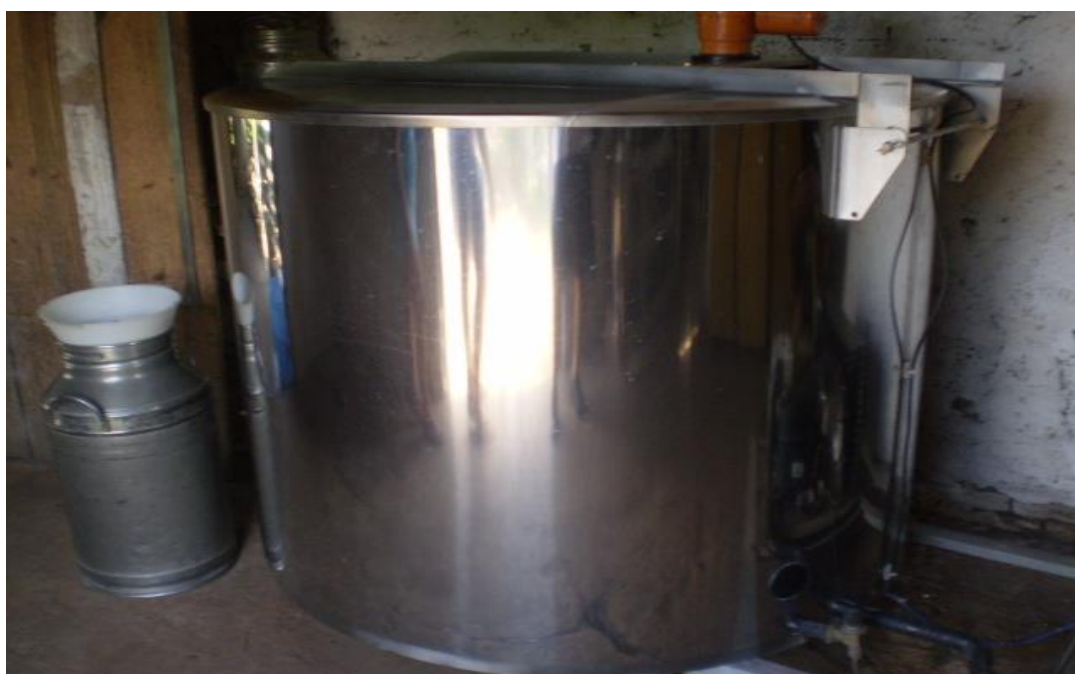
Figura 4: Tanque de expansão direta com capacidade de 2000 litros
