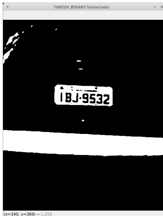
Figura 7 – Vídeo com aplicação da função THRESH_BINARY
