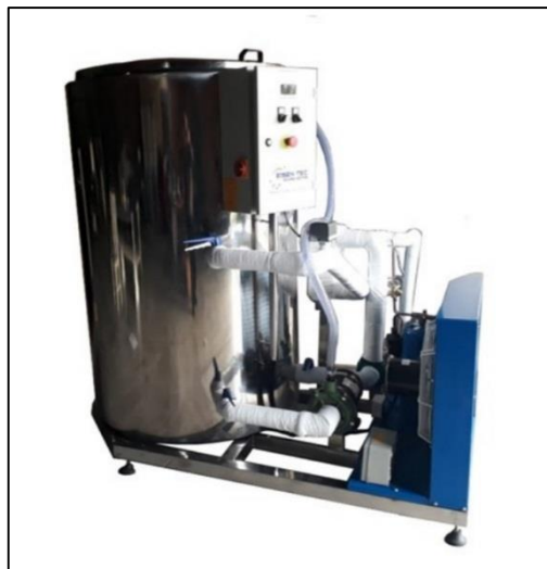
Figura 29 – Banco de líquido de resfriamento glicol
