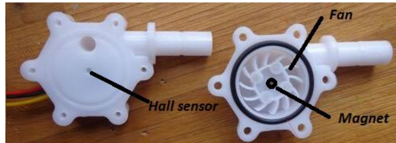
Figura 11 – Funcionamento de um sensor de fluxo
