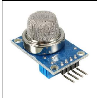
Figura 8 – Sensor de gás MQ-135
