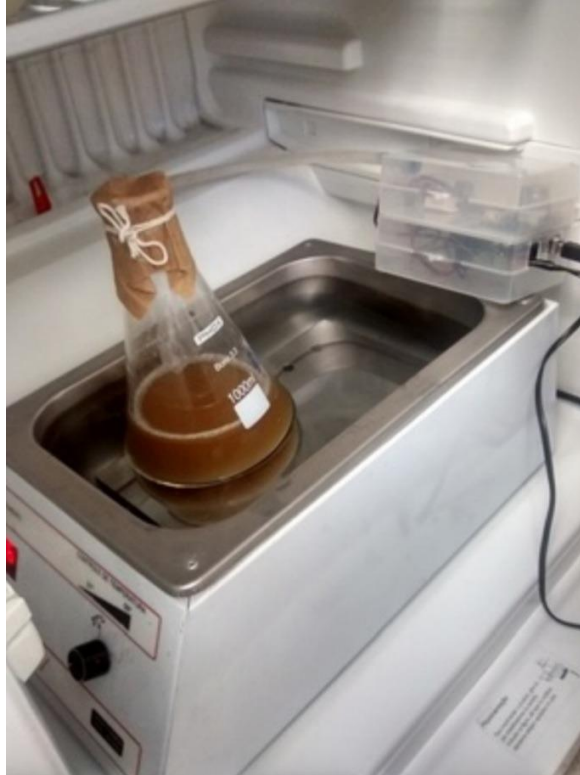
Figura 20 – Sistema de controle de temperatura
