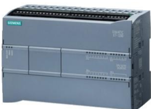
a) CLP Siemens S7
