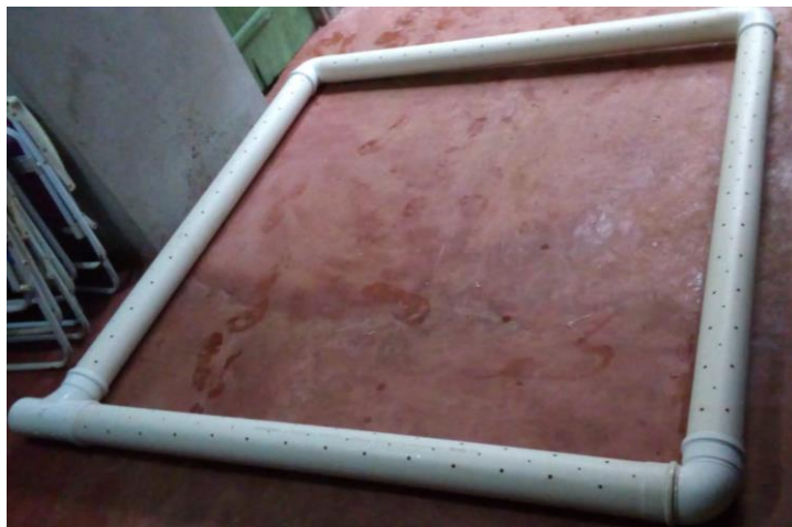
Figura 4 - Cano de distribuição montado e furado.
