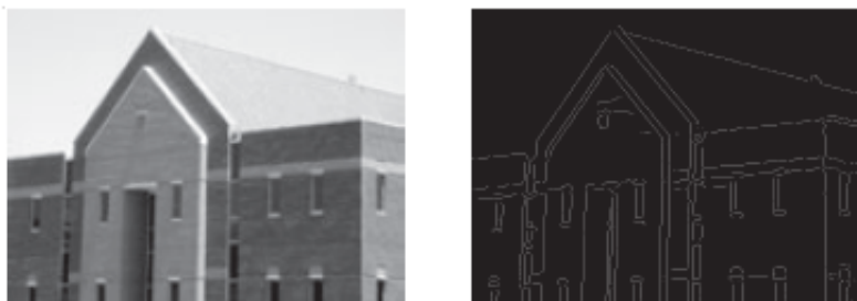
Figura 7 - Resultado da aplicação do método de Canny para detecção de bordas.
