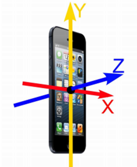
Figura 6 - Orientação dos eixos que definem as componentes da aceleração de um Smartphone
