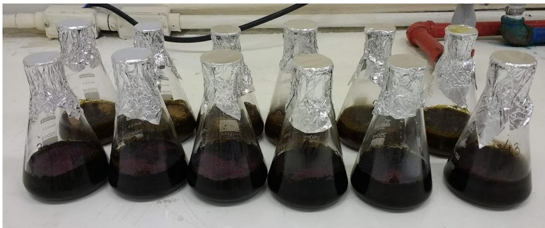
Figura 10 - Sólidos e soluções de NaOH anteriormente ao pré-tratamento em autoclave
