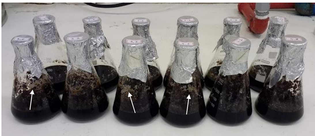
Figura 11 - Sólidos e licor exatamente após o pré-tratamento em autoclave
