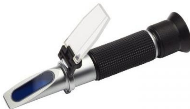
Figura 7 - Refratômetro Analógico utilizado para medida do °Brix dos licores
