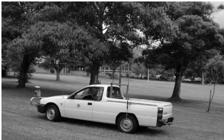
Figura 6 - Veículo utilizado equipado com laser 2D, telêmetro e sistema de GPS diferencial.
