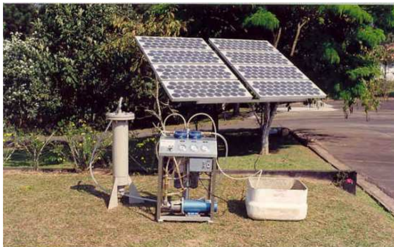
Figura 3 - Protótipo para irrigação alimentado por energia solar.
