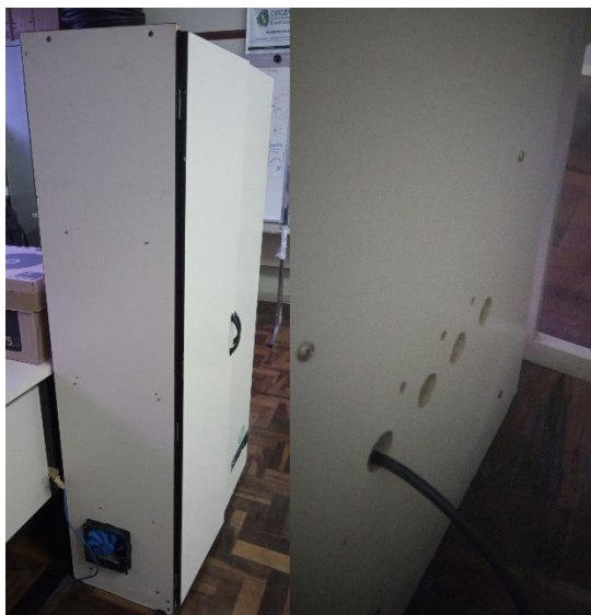
Figura 14 – Ventilação da secção inferior do móvel.
