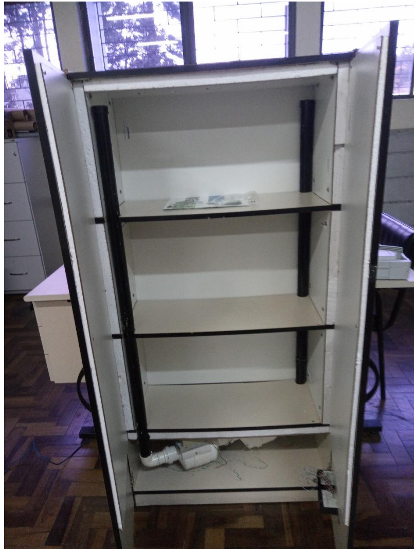
Figura 7 - Gabinete com o isolamento e tubos de circulação de ar
