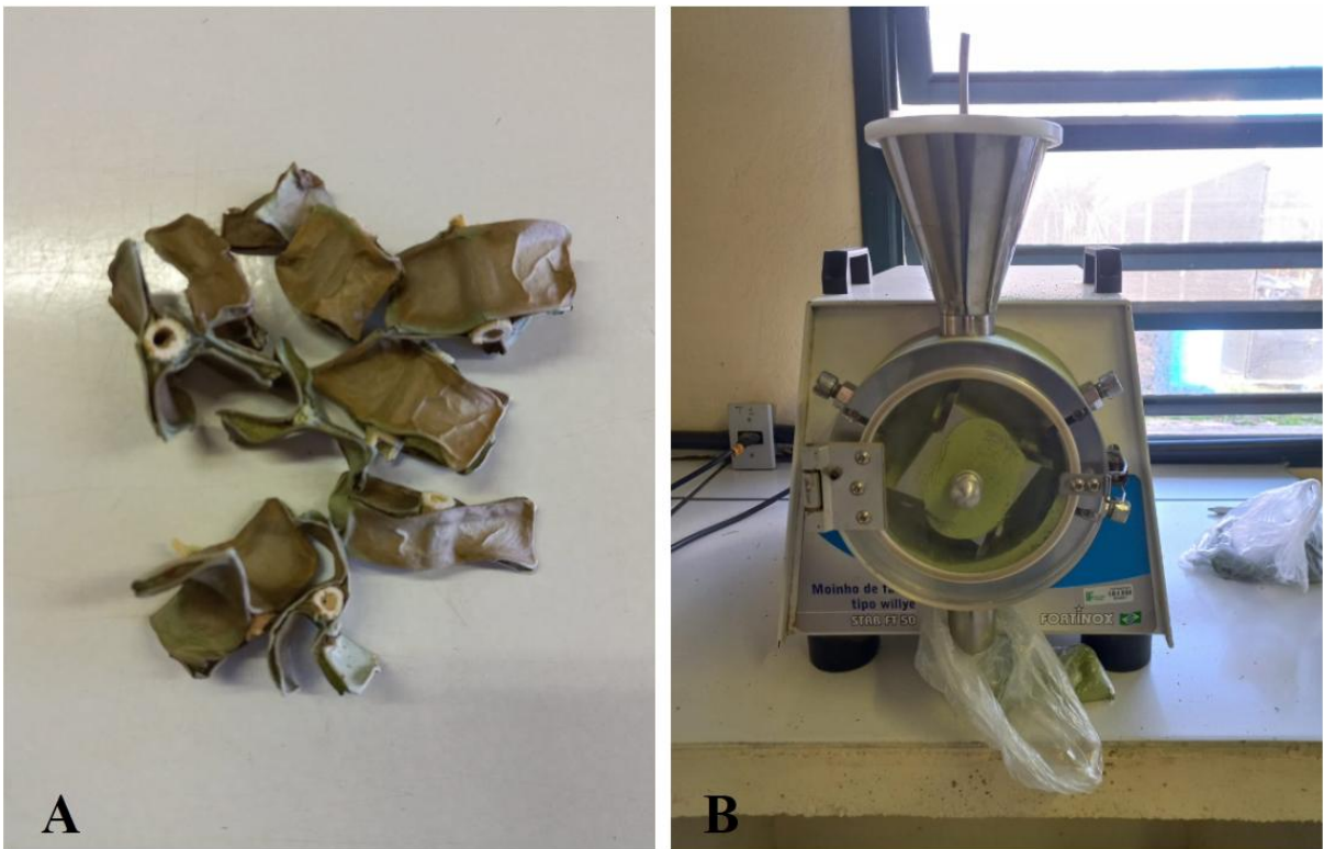
Figura 4 - Etapa de moagem para preparo do pó. a) Cladódio de pitaia após secagem; b) Processo de moagem dos cladódios secos.
