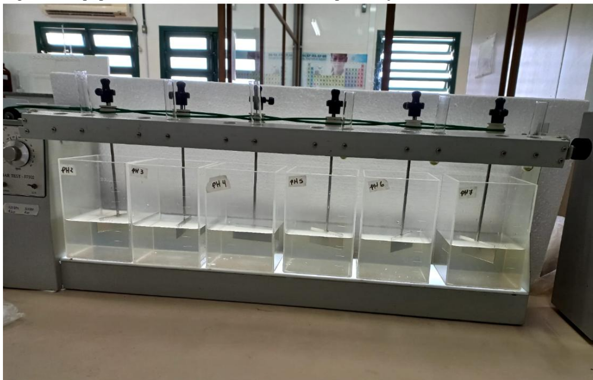
Figura 7 - Equipamento JarTest com barra dosadora para adição dos tratamentos.
