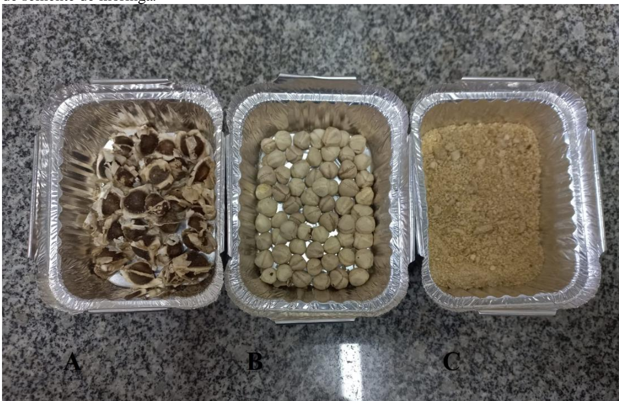
Figura 6 - Resultados das etapas de preparação do pó de semente de moringa ( Moringa oleifera Lam.). a) Semente de moringa com casca; b) Semente de moringa descascada; c) Pó de semente de moringa.
