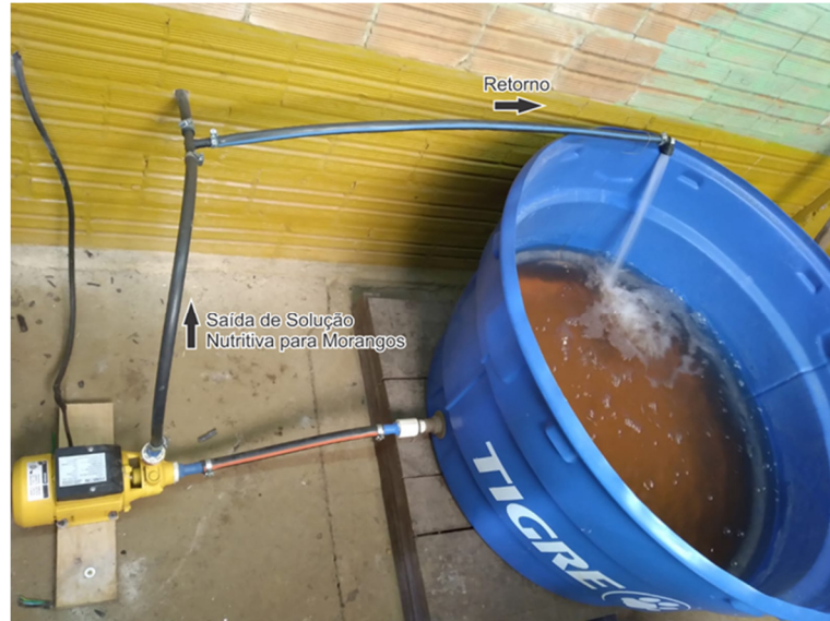
Figura 6.5: Conjunto reservatório e motobomba conectados. Fonte: Autores (2022).
