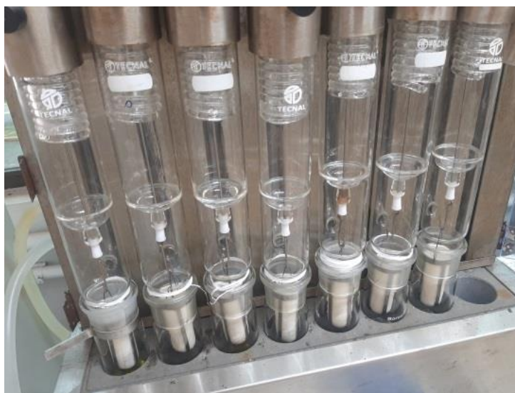
Figura 5 - Extrator de lipídio Soxhlet com amostras das diferentes formulações de ração pet para gatos
