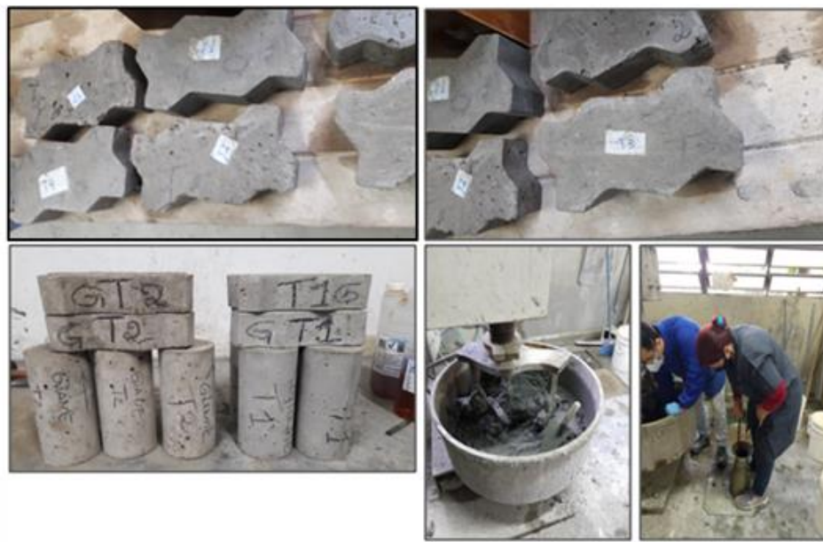
Figura 21 – Imagem com o bloco de concreto e os corpos de prova produzidos na dissertação
