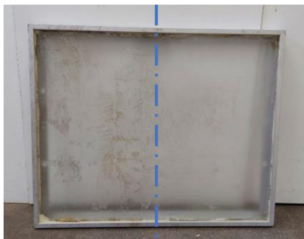
Figura 24 – Amostra B, parte do EVA impregnado removido.
