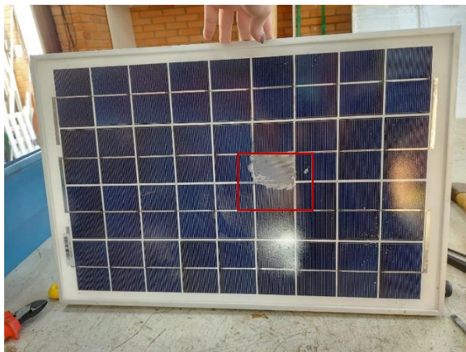
Figura 15 – Vista frontal do Módulo A após remoção das camadas de EVA e de células de Si, numa área pontual.
