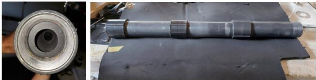
Figura 28 - Tubo colimador desenvolvido para o experimento.
