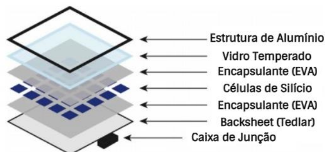
Figura 7 - Componentes de um módulo fotovoltaico de silício cristalino
