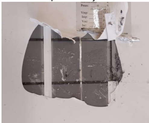
Figura 13 - Área do módulo A após remoção do backsheet (TedLar).
