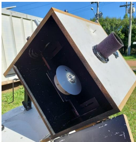
Figura 39 - Piranômetro e cabine alinhados
