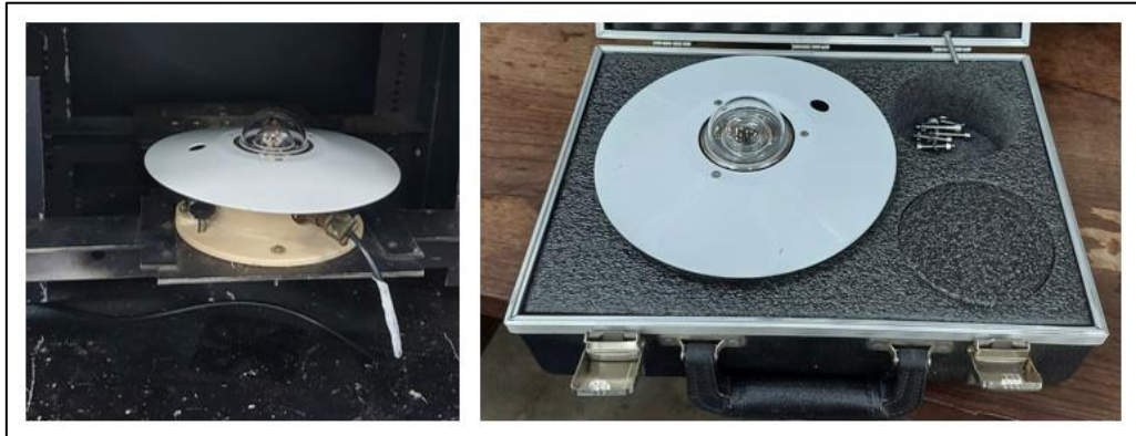
Figura 37 - Piranômetro utilizado no trabalho
