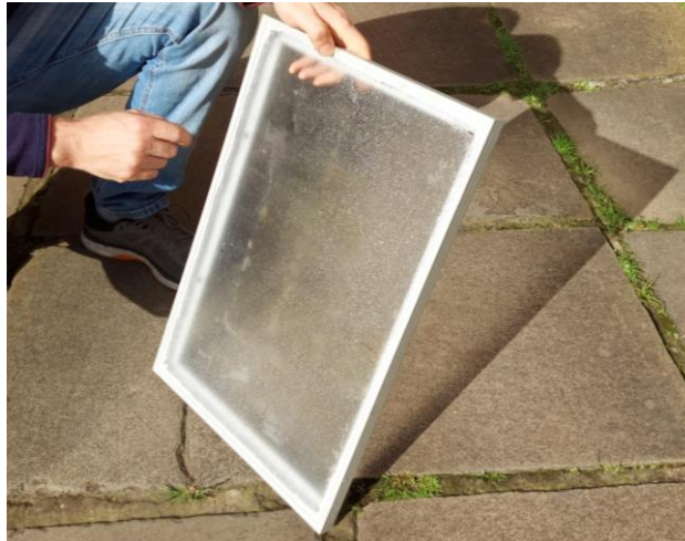
Figura 41 - Vidro do módulo recuperado com a moldura de alumínio
