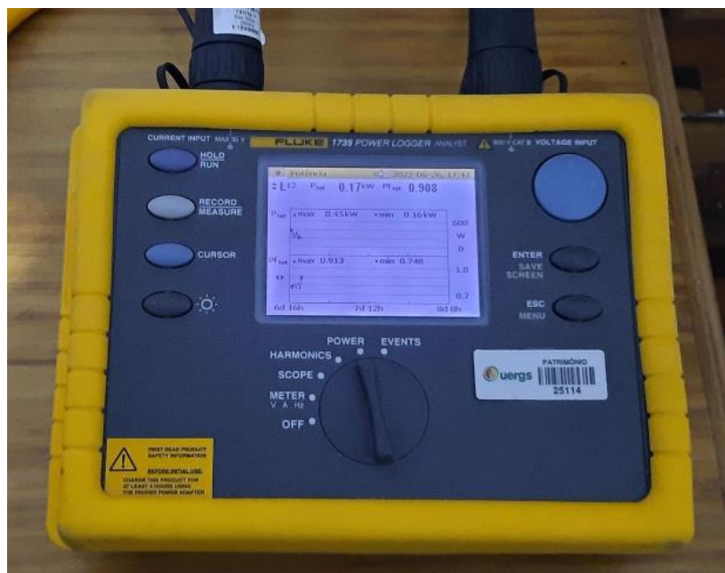
Figura 6 – Analisador de qualidade de energia elétrica da Fluke 1735.
