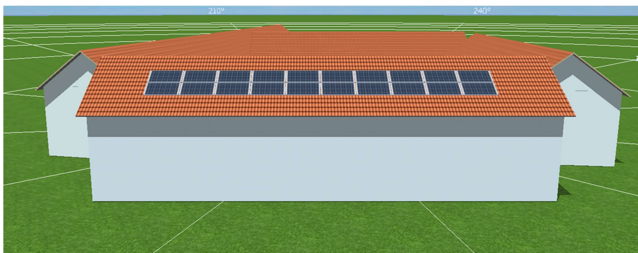
Figura 19-Disposição dos 20 módulos na simulação 3D PVsol
