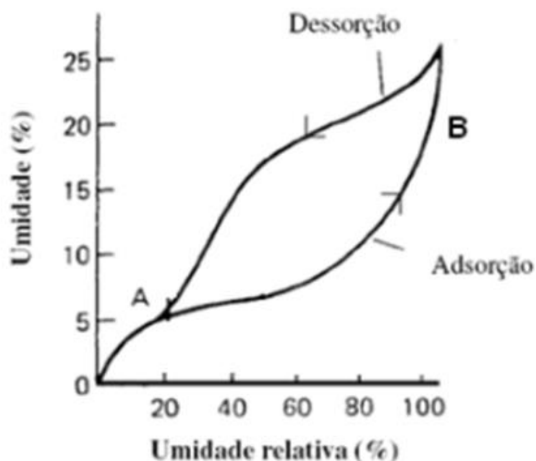
Figura 5 - Isoterma de adsorção e de dessorção típica de alimentos
