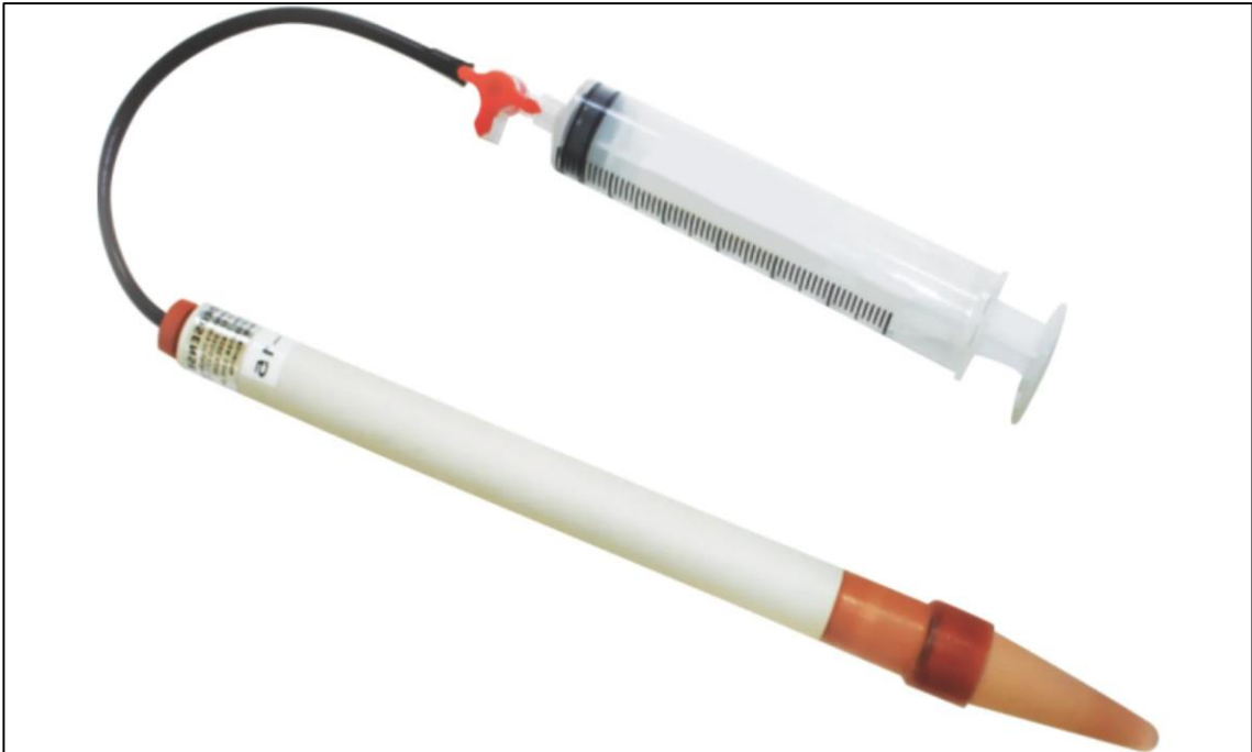
Figura 4 - Exemplo de extrator de solução do solo, utilizados para monitoramento da condutividade elétrica, pH e concentração de nutrientes na solução do solo
