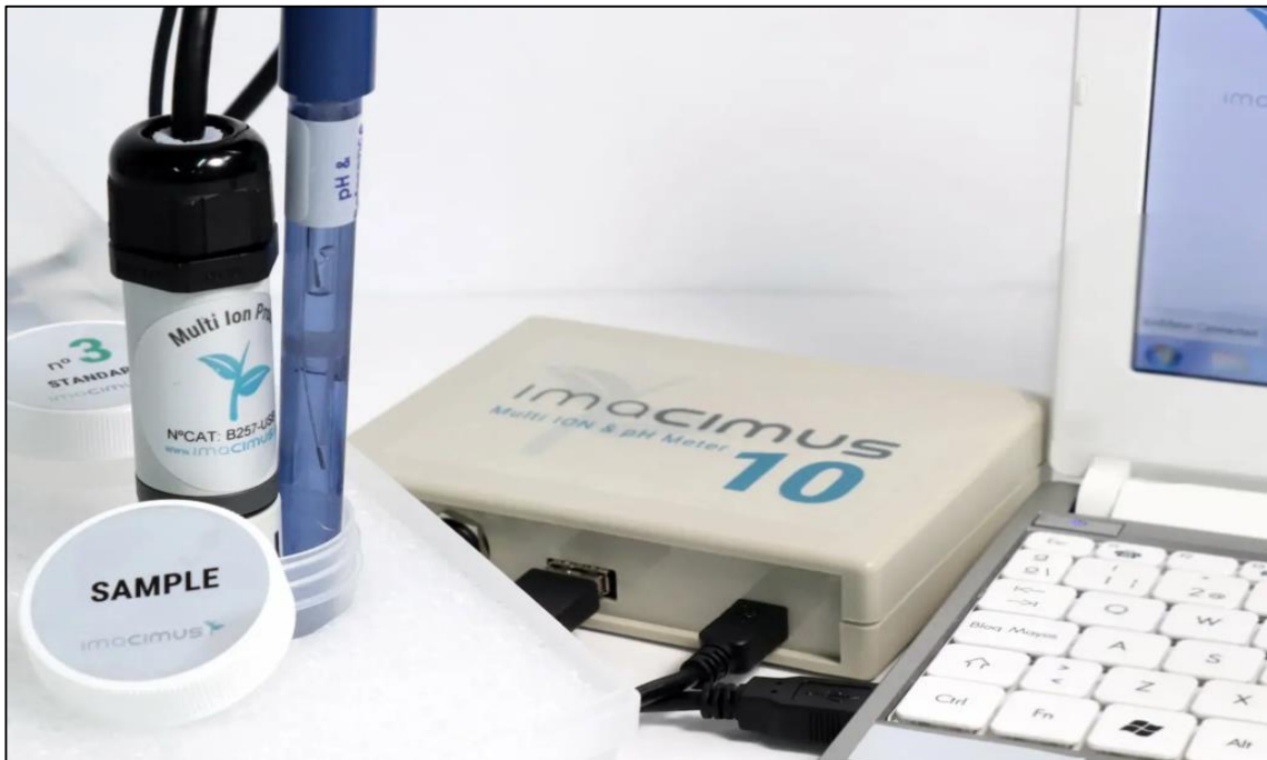
Figura 5: Exemplo de sonda multi íons modelo Imacimis, que permite a medição direta e ao mesmo tempo dos principais nutrientes e parâmetros químicos da amostra
