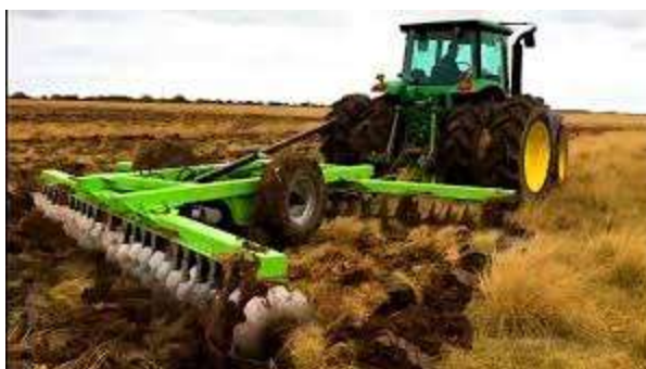
Figura 3 – Emprego de grade aradora no preparo inicial do solo.
