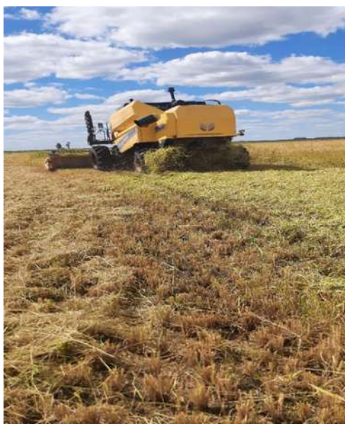
Figura 21 – Colheitadeira equipada com picador e espalhador de palhada
