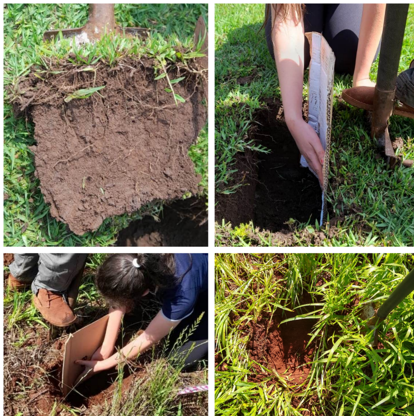
Figura 04: Coleta de amostras em blocos de solo com estrutura preservada na camada de 0 a 25 cm de profundidade seguindo a metodologia DRES – Diagnóstico Rápido da Estrutura do Solo.
