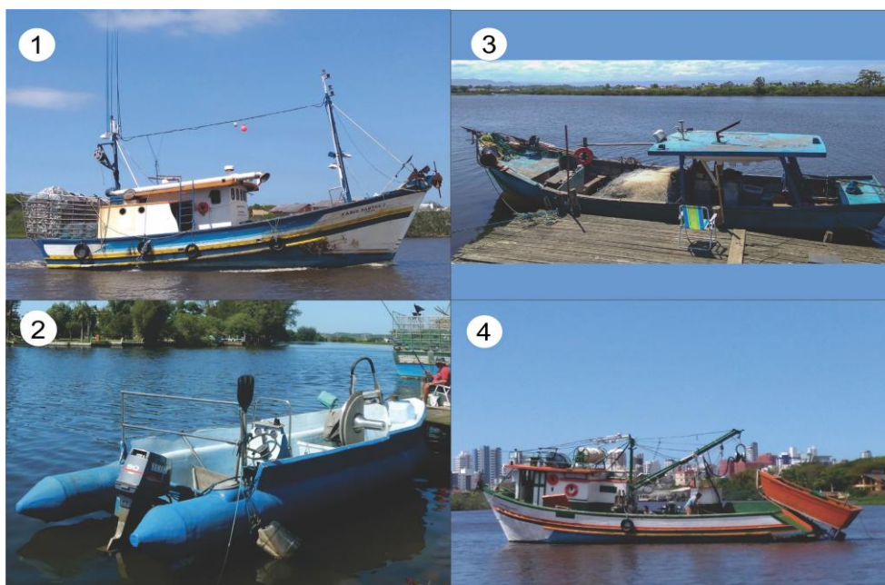
Figura 1.6 - Embarcações da comunidade pesqueira de Passo de Torres/SC e Torres/RS. 1) barco de malha; 2) lancha; 3) bote; 4) traineira com caíco.
