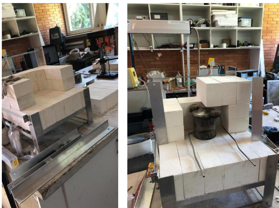
Figura 20 - Concepção intermediária do forno mufla avaliando a disposição dos tijolos para utilização com o reator de pirólise
