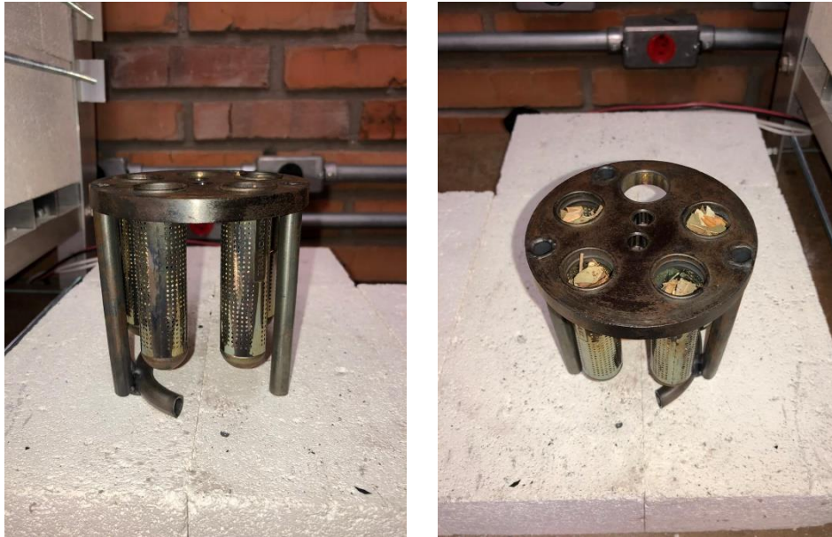
Figura 18 - Suporte da biomassa antes do processo de pirólise.
