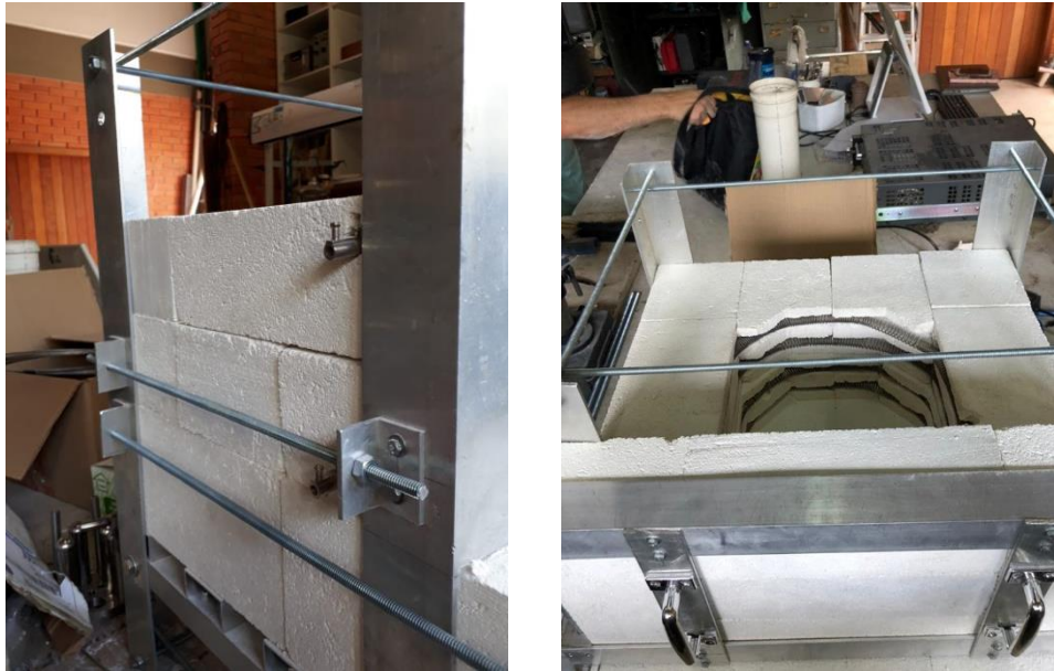
Figura 21 - Estrutura construída para suporte do forno
