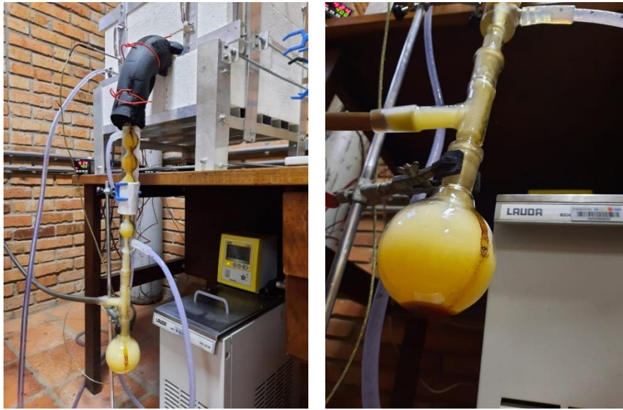
Figura 32 - Esquemática final da unidade a produção de bio-óleo durante o processo
