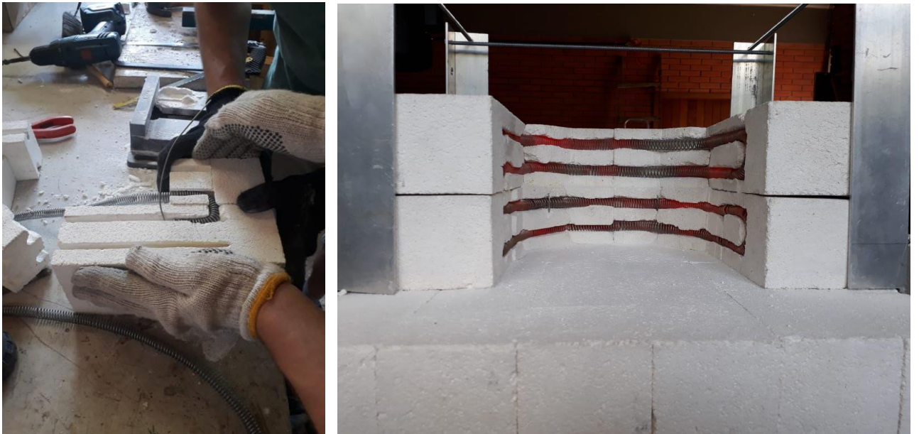
Figura 26 - Escavação dos tijolos, a colocação da resistência elétrica e o sistema em testes
