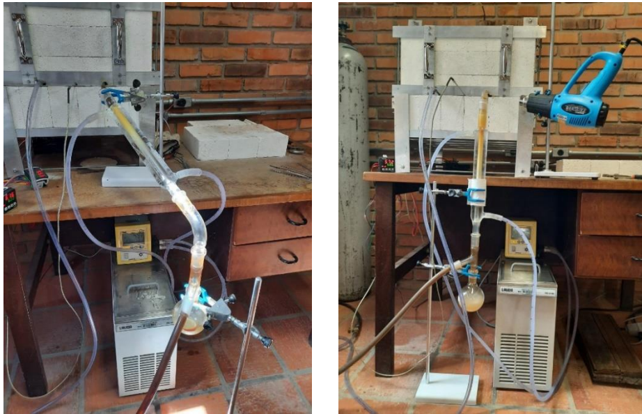
Figura 31 - Configurações avaliadas para superar a dificuldade de condensação antecipada do óleo pirolítico
