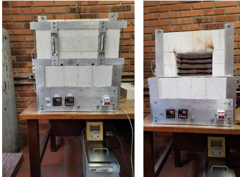
Figura 29 - Controle de temperatura implementado em sua configuração final no forno mufla
