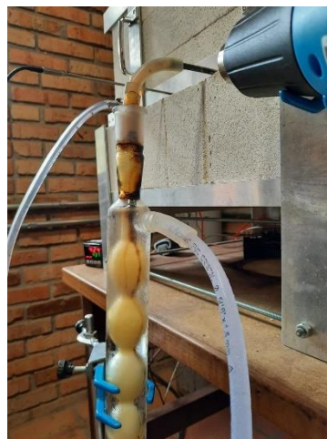
Figura 30 - Óleo de pirólise condensando antes de entrar no condensador
