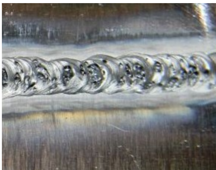
Figura 4 - Imagem de solda com porosidade
