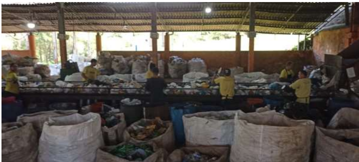
Figura 9 - Esteira na Estação de Manejo - Setor 2, onde é feita a triagem dos materiais
