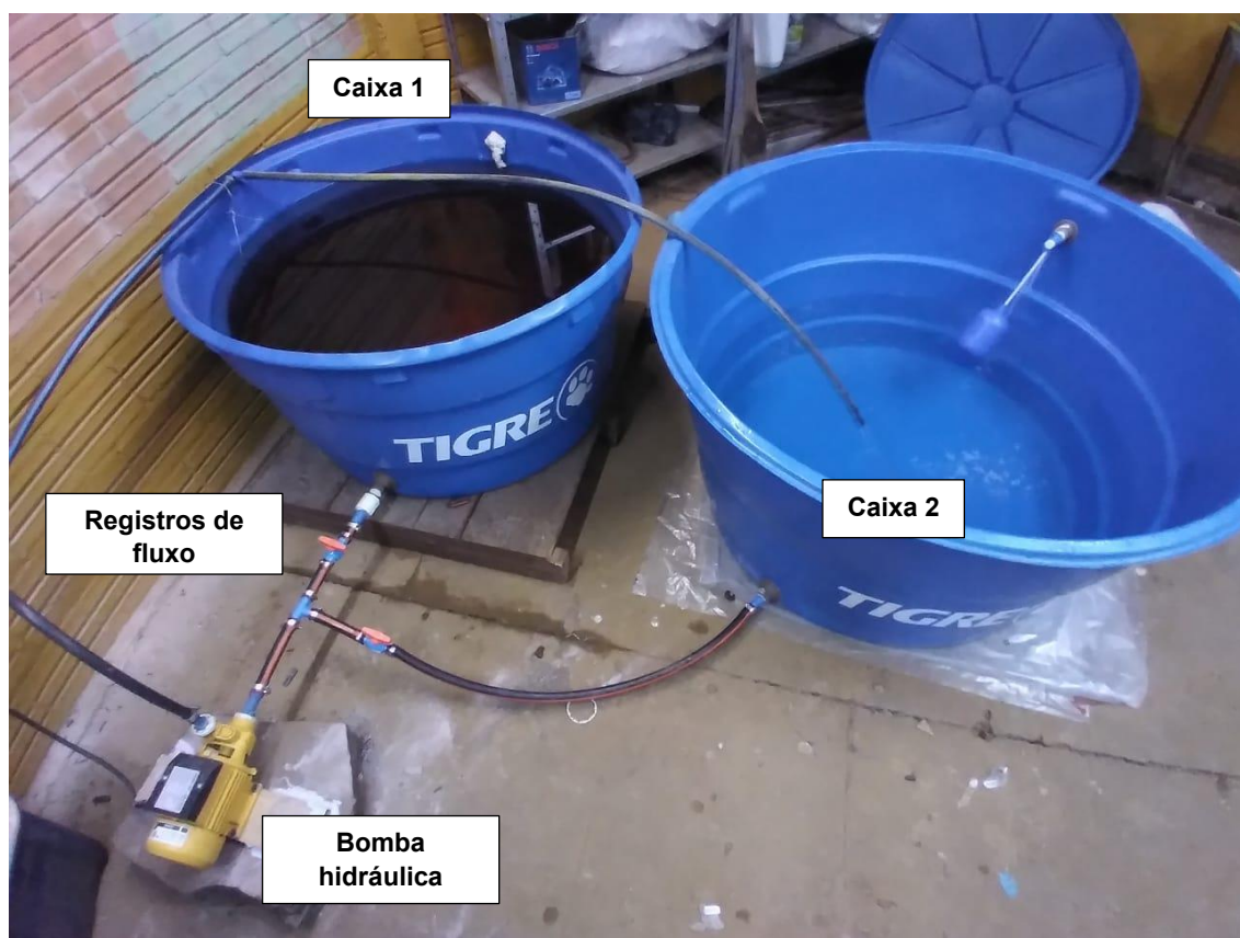
Imagem 2: Sistema Hidráulico Interno de Irrigação
