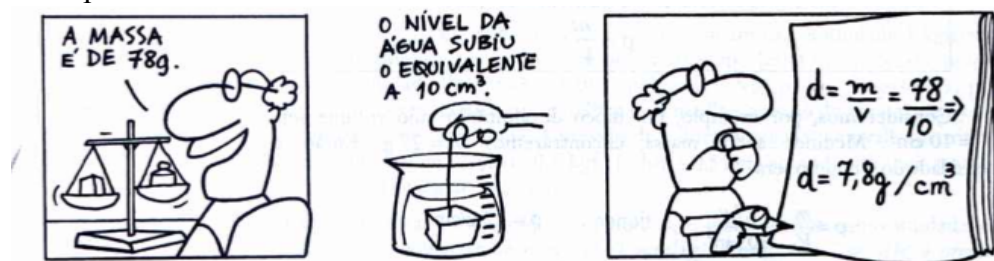
Fig.1: Experiência para determinar o valor da densidade de um corpo (representada por d).
