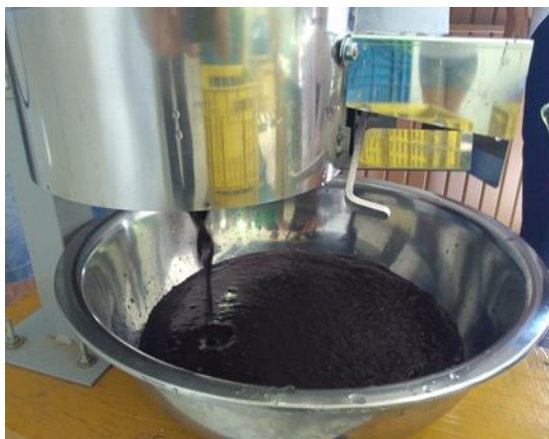
Figura 6 - Polpa de açaí-juçara após a despolpa.
