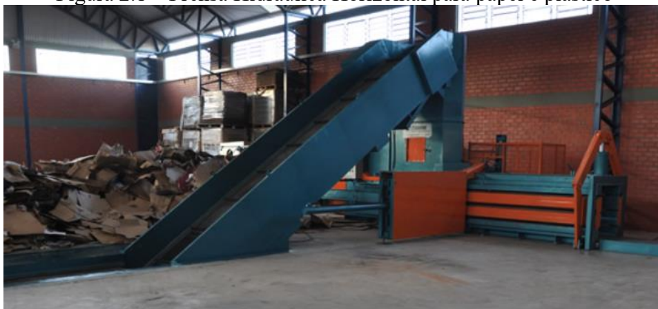
Figura 2.1 – Prensa Hidráulica Horizontal para papel e plástico
