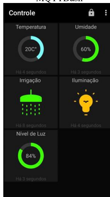
Figura 19.21 - Dashboard do aplicativo de monitoramento do cultivo hidropônico pelo MQTTDash
