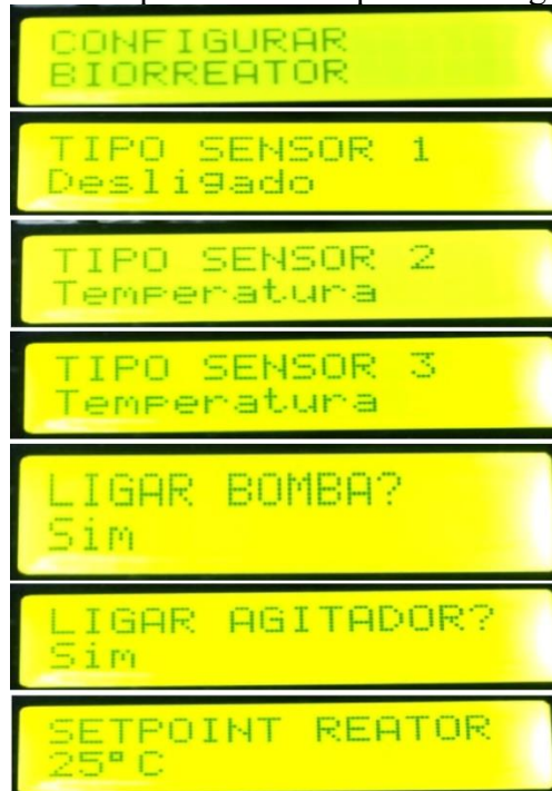
Figura 5.27 - Sequência simplificada de etapas da configuração do biorreator
