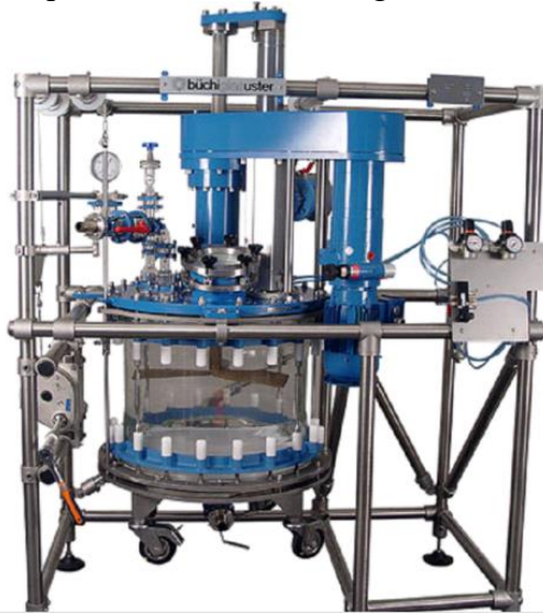
Figura 5.20 - Exemplo de um reator com agitador/misturador industrial
