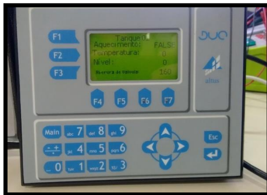
Figura 1.6 - Interface Humano Máquina utilizada no estudo
