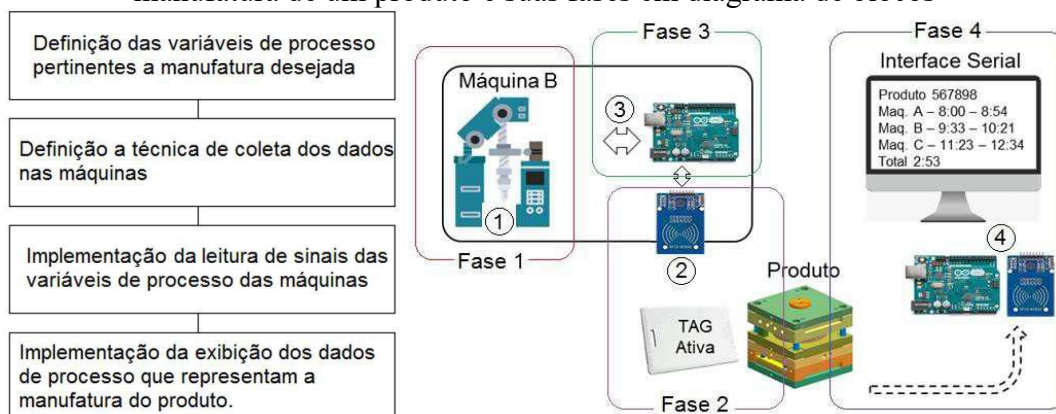
Figura 18.5 – Método proposto para coleta automatizada de dados do processo de manufatura de um produto e suas fases em diagrama de blocos
