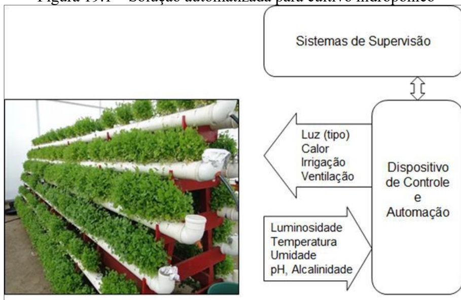
Figura 19.1 – Solução automatizada para cultivo hidropônico
