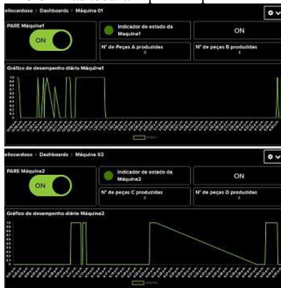
Figura 13.8 – Dashboard específica para cada máquina
