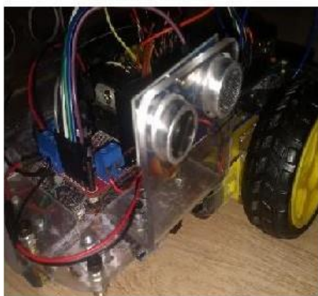
Figura 14.1 – AVG seguidor de proximidade e de linha
