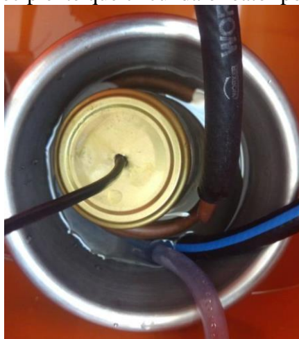
Figura 5.5 - Recipiente que circunda o reator por troca térmica
