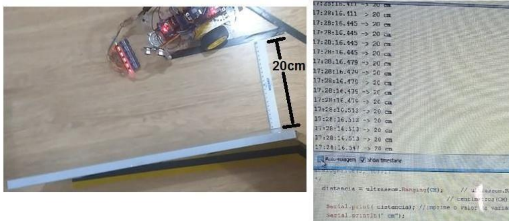
Figura 14.16 - Monitoramento serial do sensor ultrassônico na pista de teste
