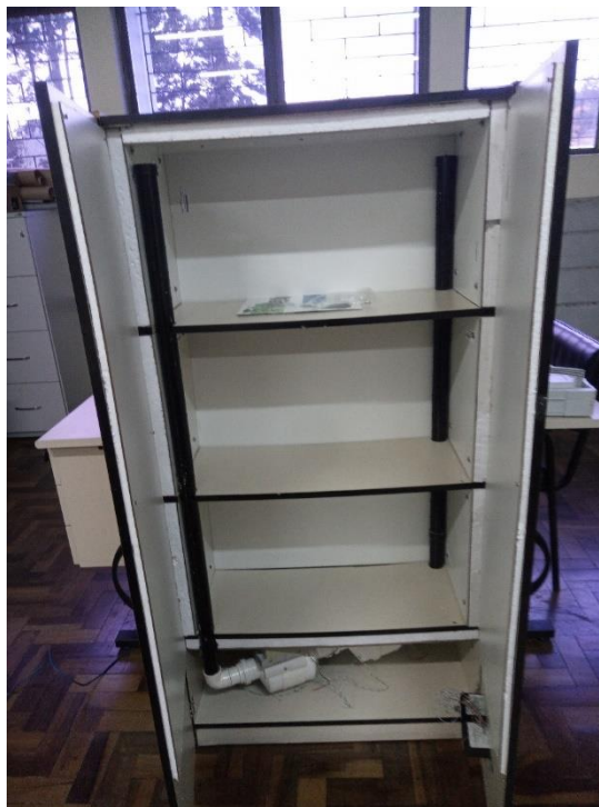
Figura 6.7 - Gabinete com o isolamento e tubos de circulação de ar
