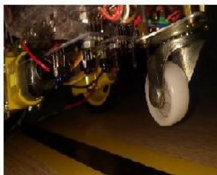
Figura 14.1 – AVG seguidor de proximidade e de linha
