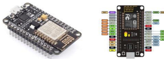
Figura 13.1 – Módulo ESP8266 NodeMCU e sua pinagem
