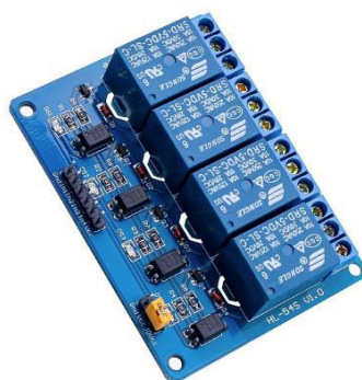
Figura 16.5 – Modulo relé com 4 canais
