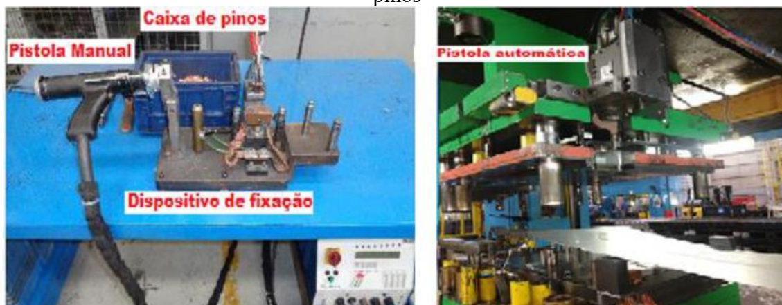
Figura 15.18 - Máquina de solda manual e pistola automática com alimentação de pinos
