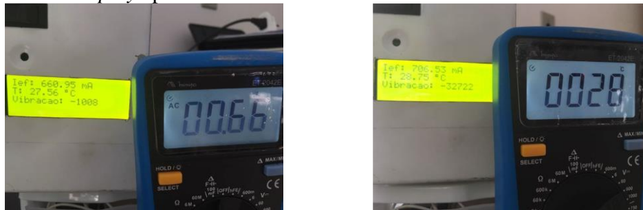
Figura 4.7 - Display apresentando mesmo valor de corrente elétrica do multímetro
