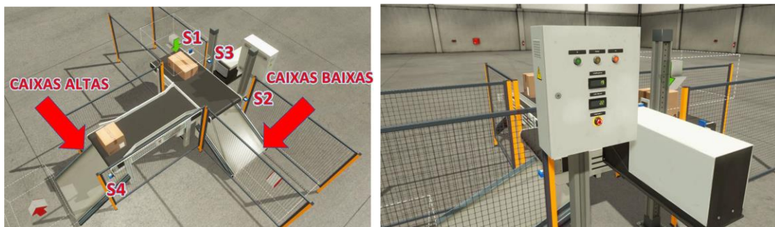
Figura 11.8 - Disposição dos sensores na planta virtualizada e componentes no quadro de comando virtual
