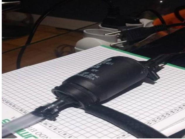
Figura 5.15 - Bomba para circulação de água no encamisamento do reator
