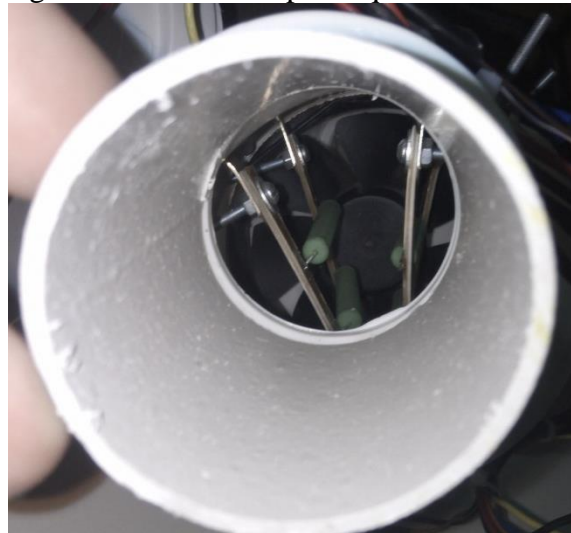
Figura 6.12 - Sistema para aquecimento do ar
