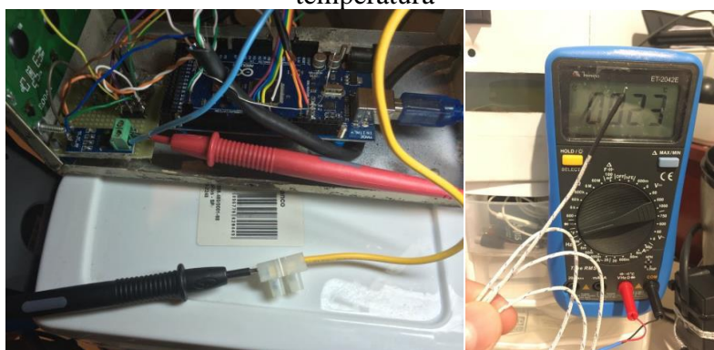
Figura 4.3 - Ligação em série do multímetro com o sensor de corrente e sensor de temperatura
