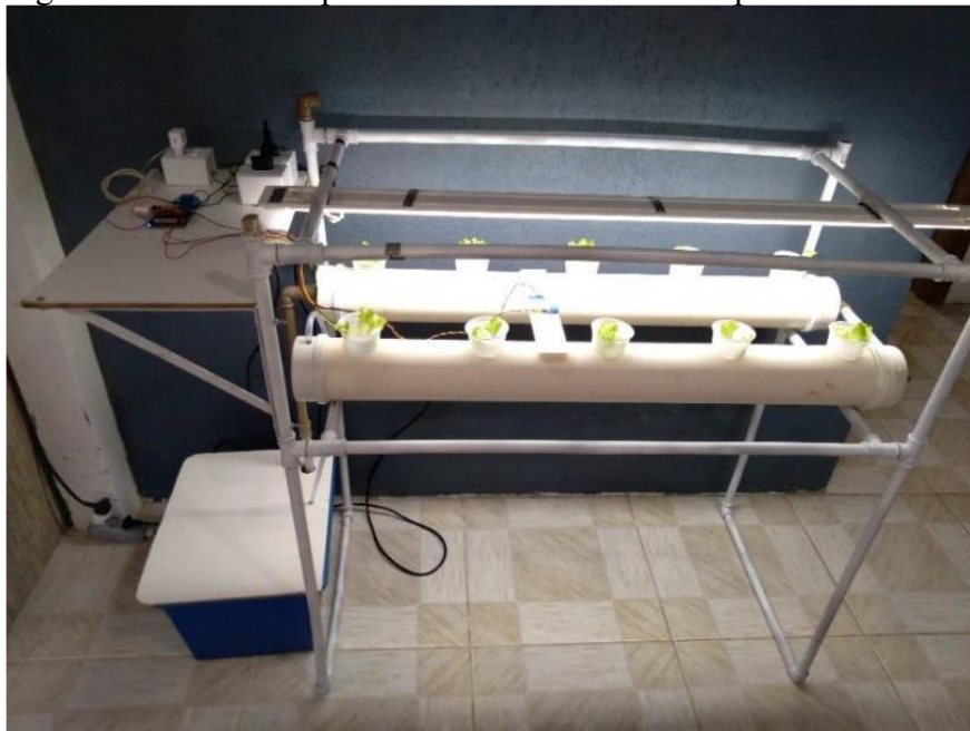
Figura 19.22 – Protótipo funcional de cultivo hidropônico finalizado
