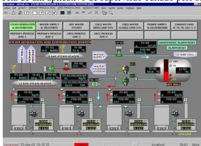
Figura 8.1 – Tela de um aplicativo de supervisão editado pelo software Elipse
