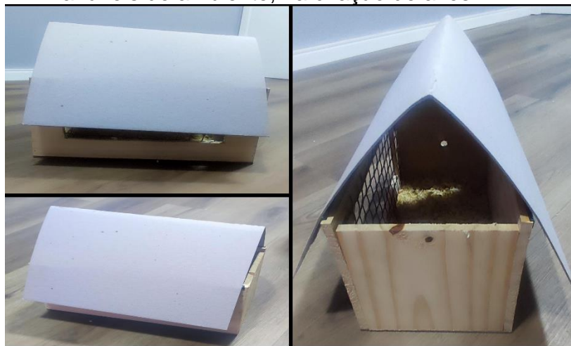
Figura 19 - Montagem estrutural da prova de conceito para monitoramento das variáveis de ambiente, na criação de aves
