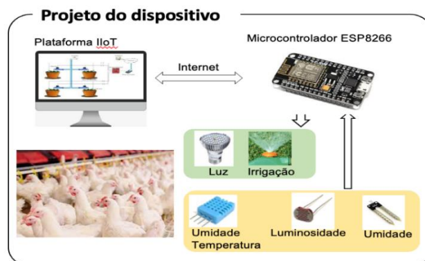
Figura 1 – Projeto do dispositivo de monitoramento das variáveis em uma produção avícola
