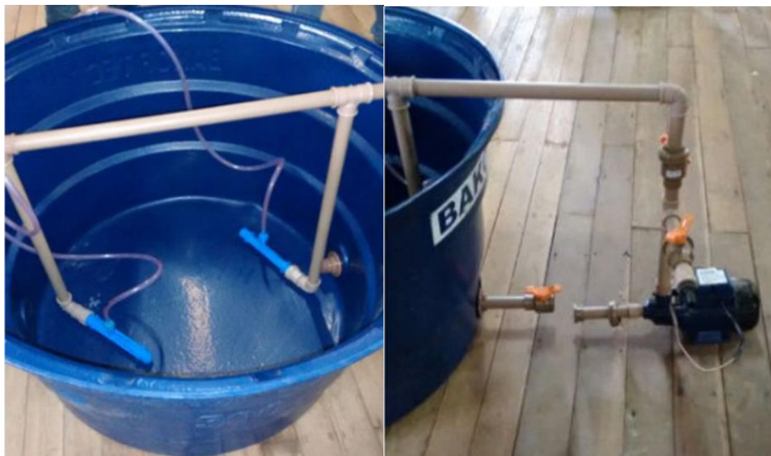
Figura 8: Sistema para fermentação on farm em caixa d'água, parte interna (esquerda) e parte externa (direita). Fonte: Janaína T. Bernardo, 2022.
