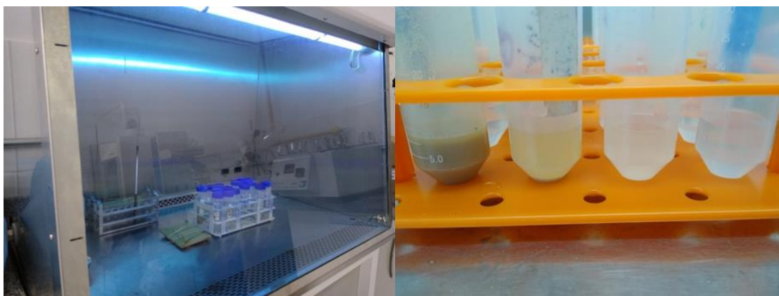
Figura 2: Processo de descontaminação feito ao expor as amostras a luz UV (esquerda) e logo ser feita as diluições seriadas de cada amostra (direita). Fonte: Autor, 2019.
