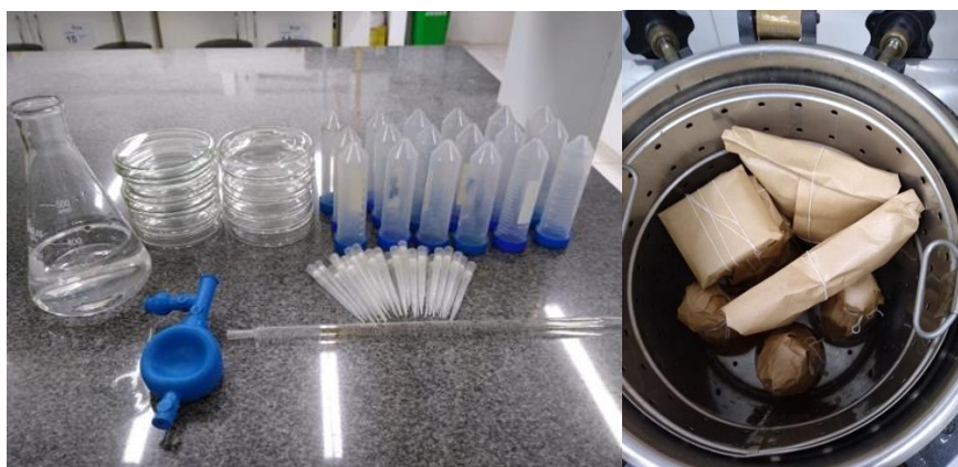
Figura 1: Preparo dos materiais (esquerda) e processo de autoclavagem (direita) empregados no processo de controle de qualidade dos produtos a base de Bacillus . Fonte: Autor, 2019
