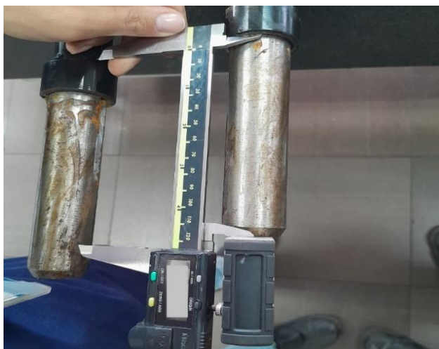
Figura 11 - Medida da ponta do eixo até a bucha.
