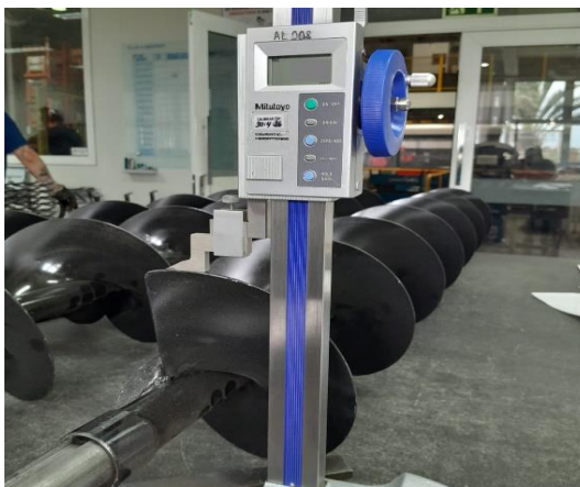
Figura 8 - Medida da ala para obtenção do diâmetro externo da rosca.
