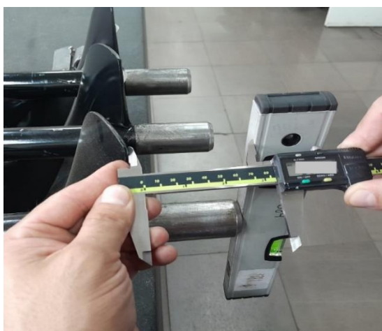
Figura 9 - Medida do início do eixo até a rosca sem fim.
