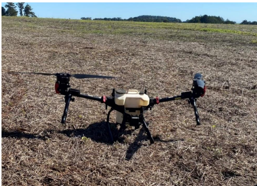
Figura 3. Drone da marca XAG modelo V40 utilizado no experimento.
