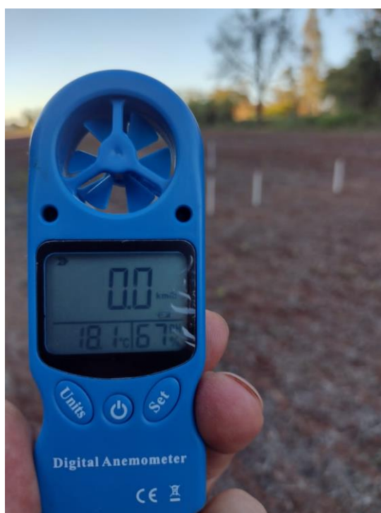
Figura 10. Termo-higro-anemômetro utilizado para verificar as condições meteorológicas no momento da realização do experimento.
