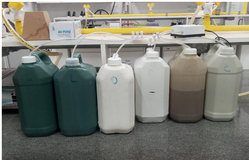
Figura 3 - Biofermentadores e tubulação de oxigenação.
