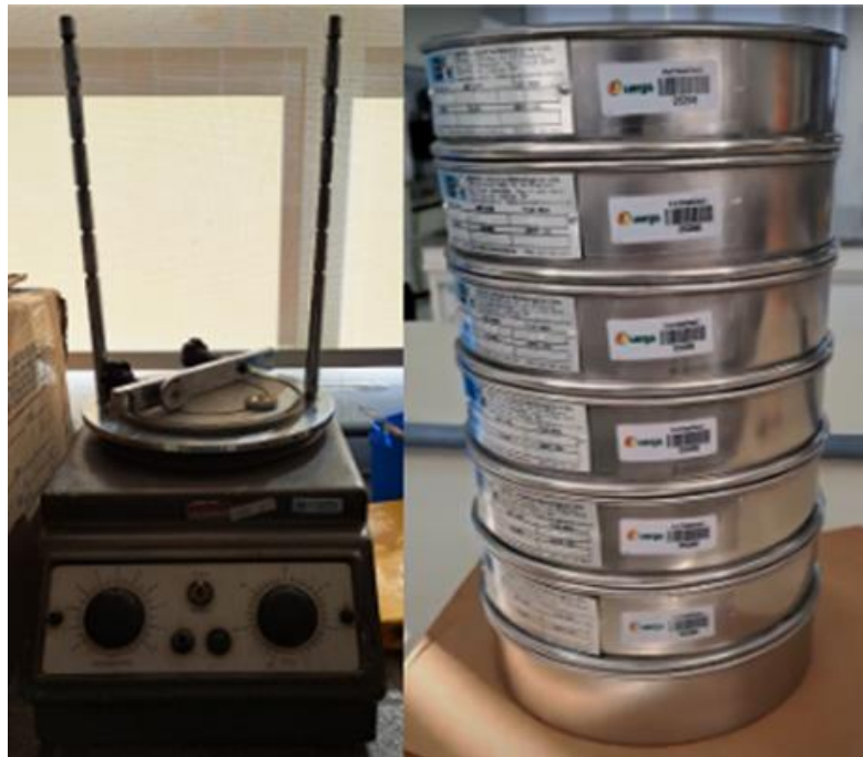
Figura 7 - Conjunto para teste de granulometria mecanizado
