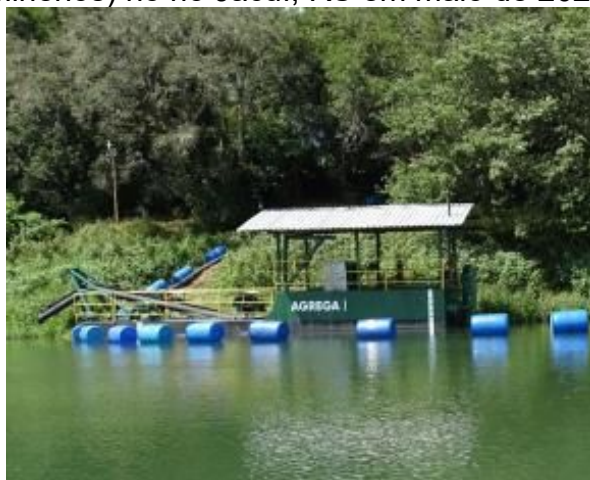
Figura 14 - Draga do tipo estacionária (com tubulação em direção ao Terminal de Minérios) no rio Jacuí, RS em maio de 2023.
