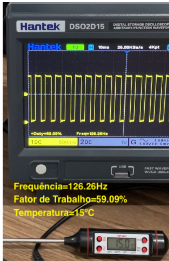
Figura 3.9 (a): Exemplo do sinal em osciloscópio a 15^{\circ}\text{C} com frequência de 126.26Hz e Fator de Trabalho de 59.09%. Autor (2023).
