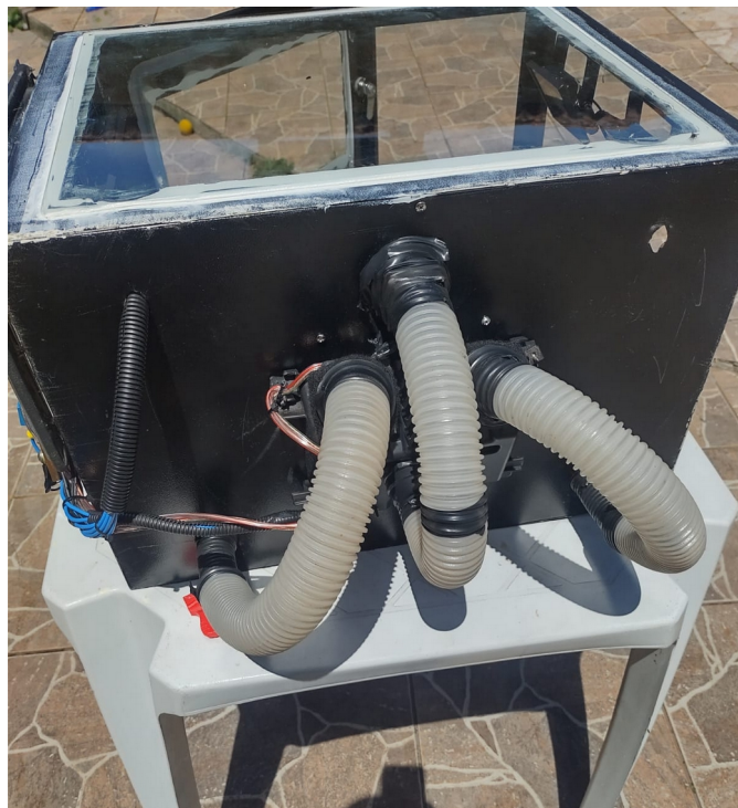
Figura 9 - Instalação do filtro de ar e dutos para recirculação.
