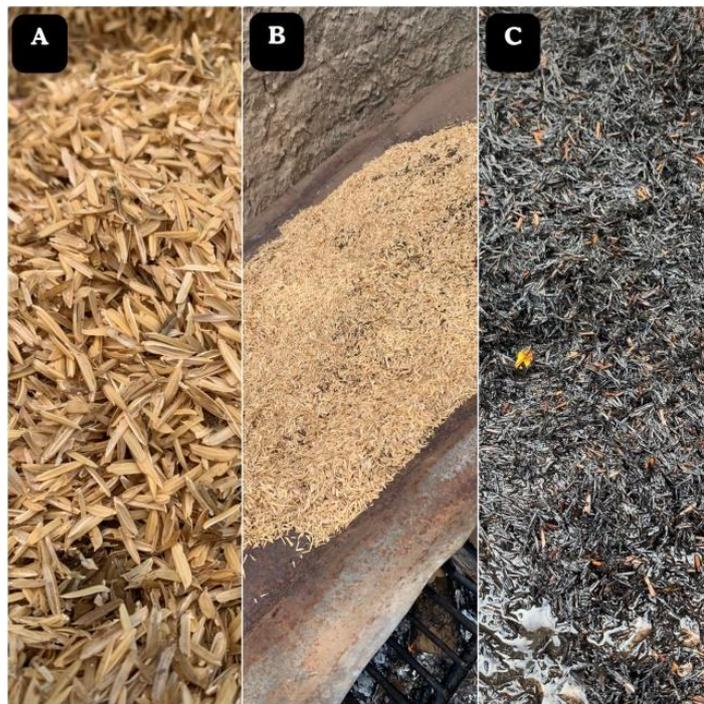
Figura 4 – Processo de carbonização da casca de arroz (A – casca crua; B - carbonização; C - casca de arroz carbonizada).
