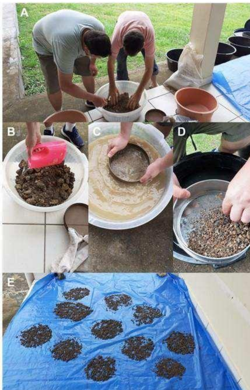
Figura 9. Preparo de Fósseis pelo método screen washing . A , desagregação de sedimentos, manualmente. B , desagregação de sedimento com auxílio de Peróxido de Hidrogênio ( H_2O_2 ). C , início da lavagem do sedimento. D , sedimentos lavados. E , secagem dos sedimentos. Após esse procedimento, os sedimentos são colocados em sacos plásticos e identificados para posterior análise sob microscópio estereoscópio para a procura de fósseis.
