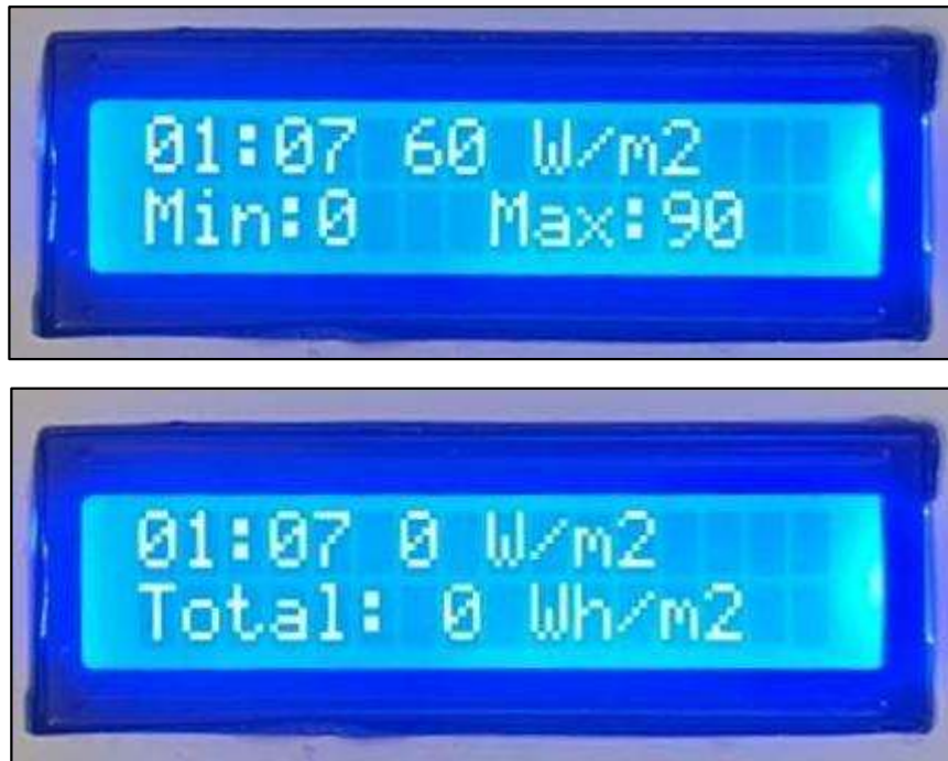
Figura 16 e 17 - Interface de visualização em tempo real no display LCD
