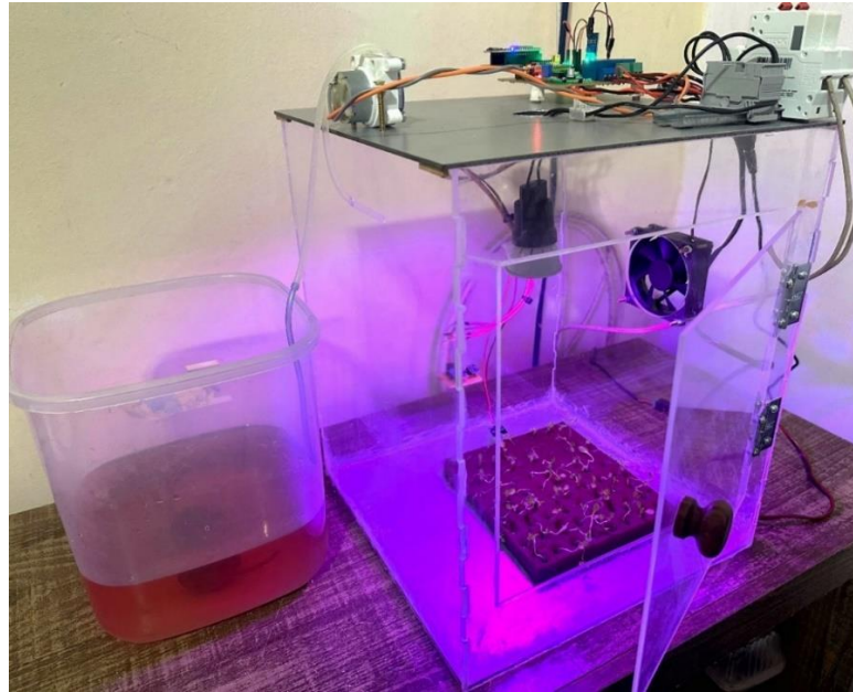
Figura 26 – Estufa automatizada confeccionada.
